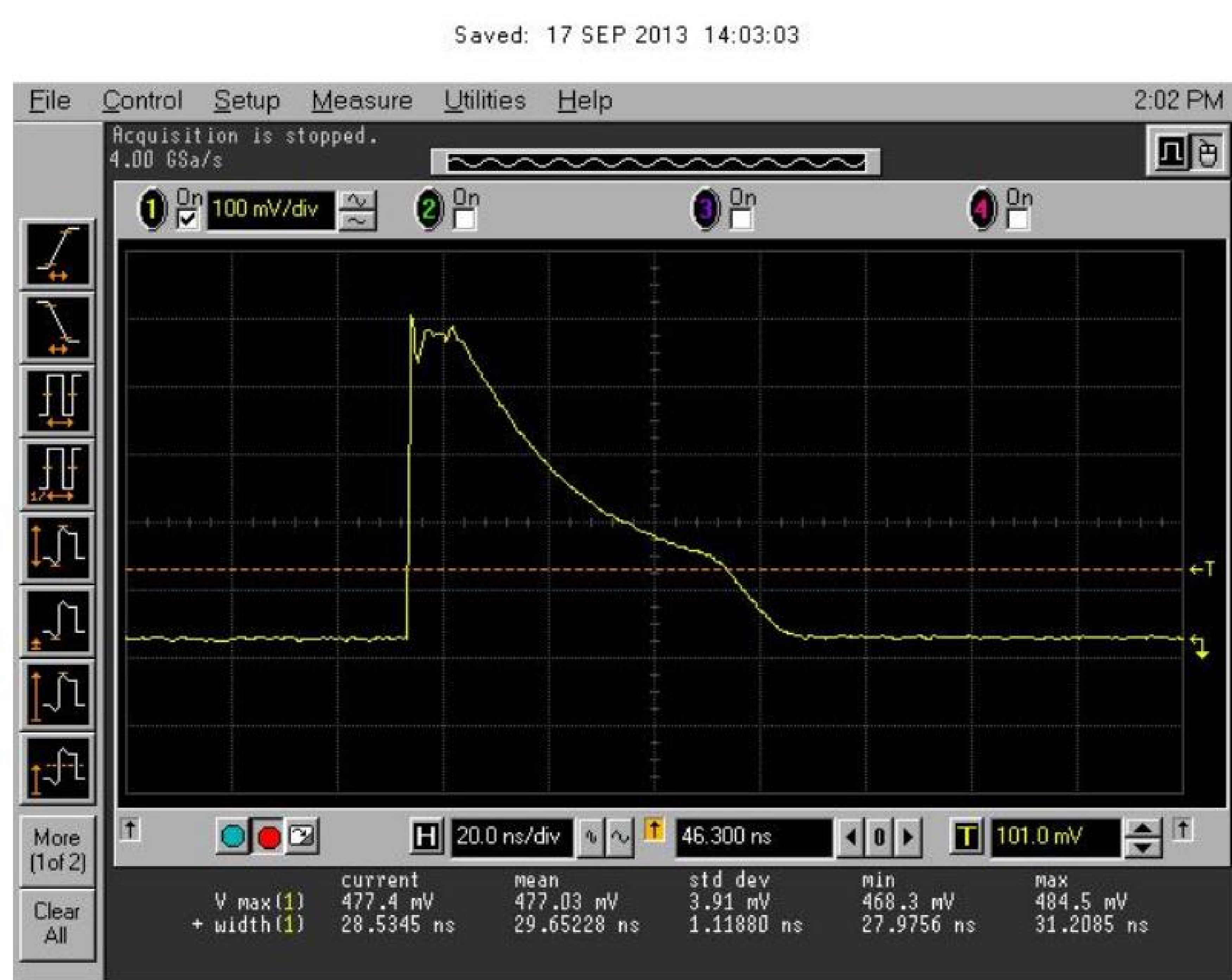
图 1. 峰值光功率 1KW (50ns) 单脉冲波形图
